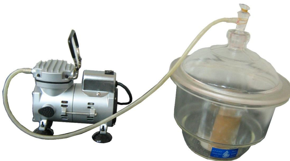
شکل ۲: دسیکاتور خلا حاوی اسید سولفوریک یا کلریدکلسیم به عنوان خشک کننده
